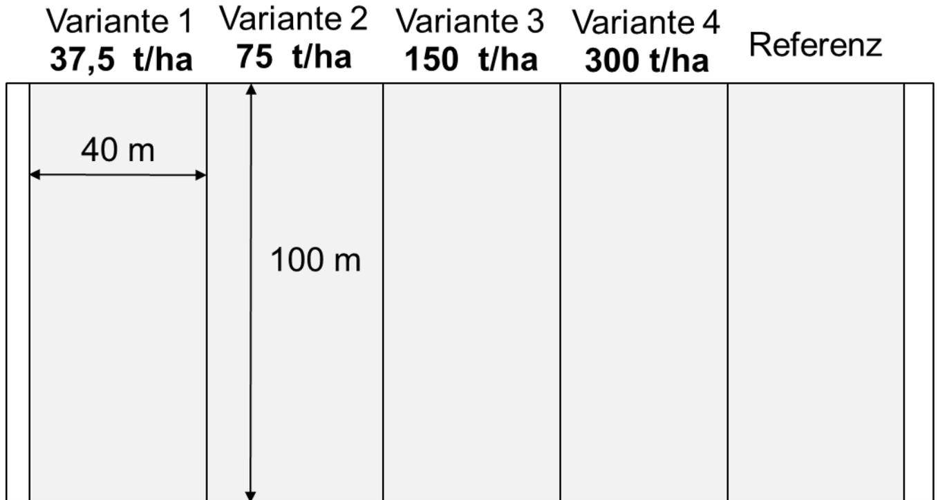
Abbildung A54: Schematische Darstellung des Versuchsdesigns auf Grünland in Streifenanlage ohne Wiederholungen und nicht randomisiert für die Aufbringung von Baggergut auf den Versuchsflächen MAR 3.1 und GEE 4.2
