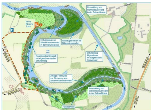
Afbeelding 6: Reactivering van een nevengeul van de Eems bij Hembergen (Kreis Steinfurt). Links: plattegrond van de maatregel, rechts: blik op de aangesloten nevengeul na de uitvoering (2018) (bron: Bezirksregierung Münster)
