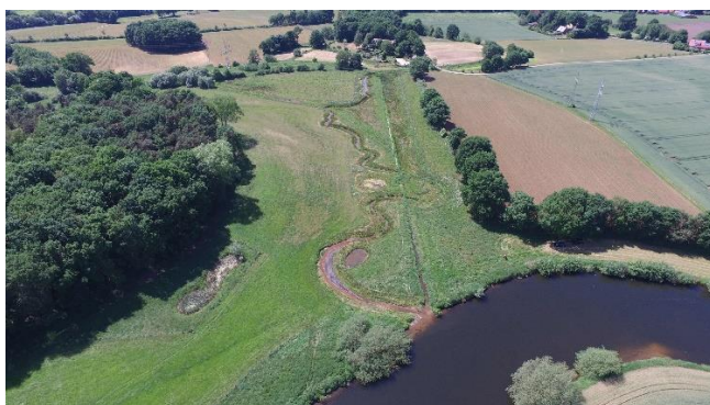
Afbeelding 7: Natuurlijke herinrichting van de Fleckenbach in de gemeente Emsbüren-Bernte (Kreis Emsbüren). Links: ontwikkeling van een uiterwaard bij de monding in de Eems, rechts: Fleckenbach ca. een jaar na uitvoering van de maatregel (bron: Hoberg, Naturschutzstiftung des Landkreises Emsland)
